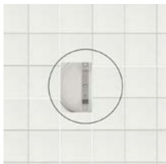
5. Retirez le baquet fibre du mur de sorte que seul le contour de l'anneau soit visible.
