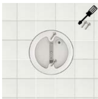
7. Remplissez le bord avec du ciment/colle à carrelage et revissez l'anneau sur le pot de manière à ce qu'il soit au ras de la surface des carreaux. Le gabque fibre peut ensuite être ajouté au ras des autres tuiles.
