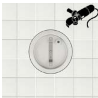
6. Retirez les carreaux, meulez les carreaux à la forme souhaitée et recollez-les.
