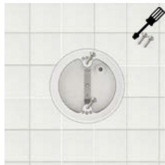
7. Füllen Sie den Rand mit Zement/Fliesenkleber und schrauben Sie den Ring wieder auf den Topf, sodass er bündig mit der Fliesenoberfläche abschließt. Der Ring kann dann bündig mit den anderen Fliesen hinzugefügt werden.
