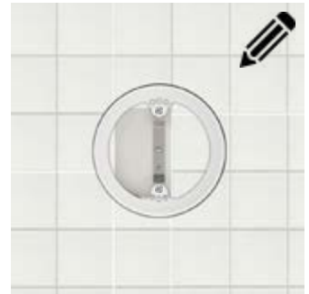
4. Markieren Sie den Montagering mit einem Marker.
