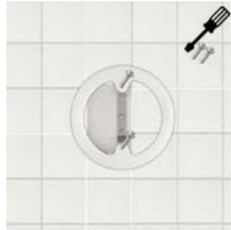
3. Setzen Sie den Ring auf das Glas und schrauben Sie ihn an das Glas.
